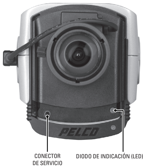
VISTA FRONTAL, CÁMARA ÚNICAMENTE (ABIERTA PARA EXHIBIR EL CONECTOR DE SERVICIO)
